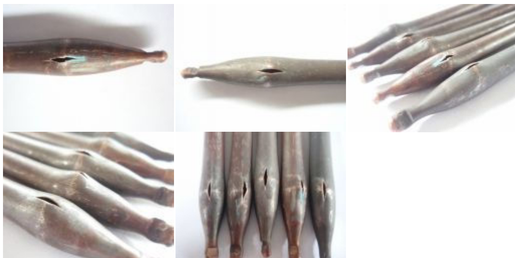
Przykładowe defekty, grupy uszkodzonych rurek
